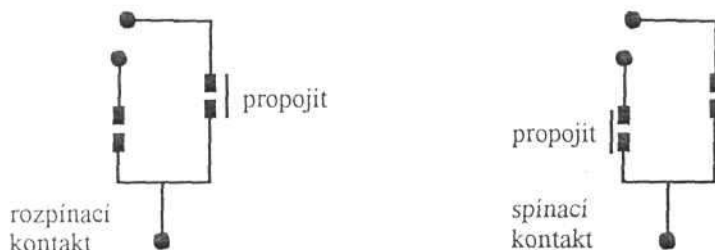
Obr. 1 Volba kontaktu relé
